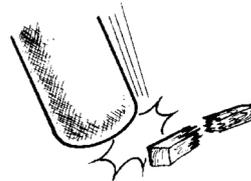
d) Cilindros con apoyo irregular por golpes, suciedad, etc.
