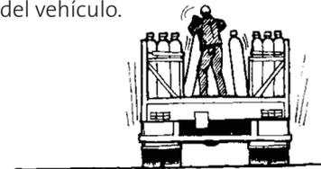
c) Descarga de camiones estacionados en una zona desnivelada, lo que provoca que los cilindros caigan hacia el centro cuando se retiran las cinchas
