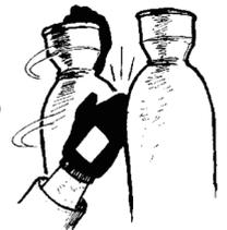
La excesiva velocidad en el traslado de los cilindros por rodamiento causa accidentes por atrapamiento de las manos.
